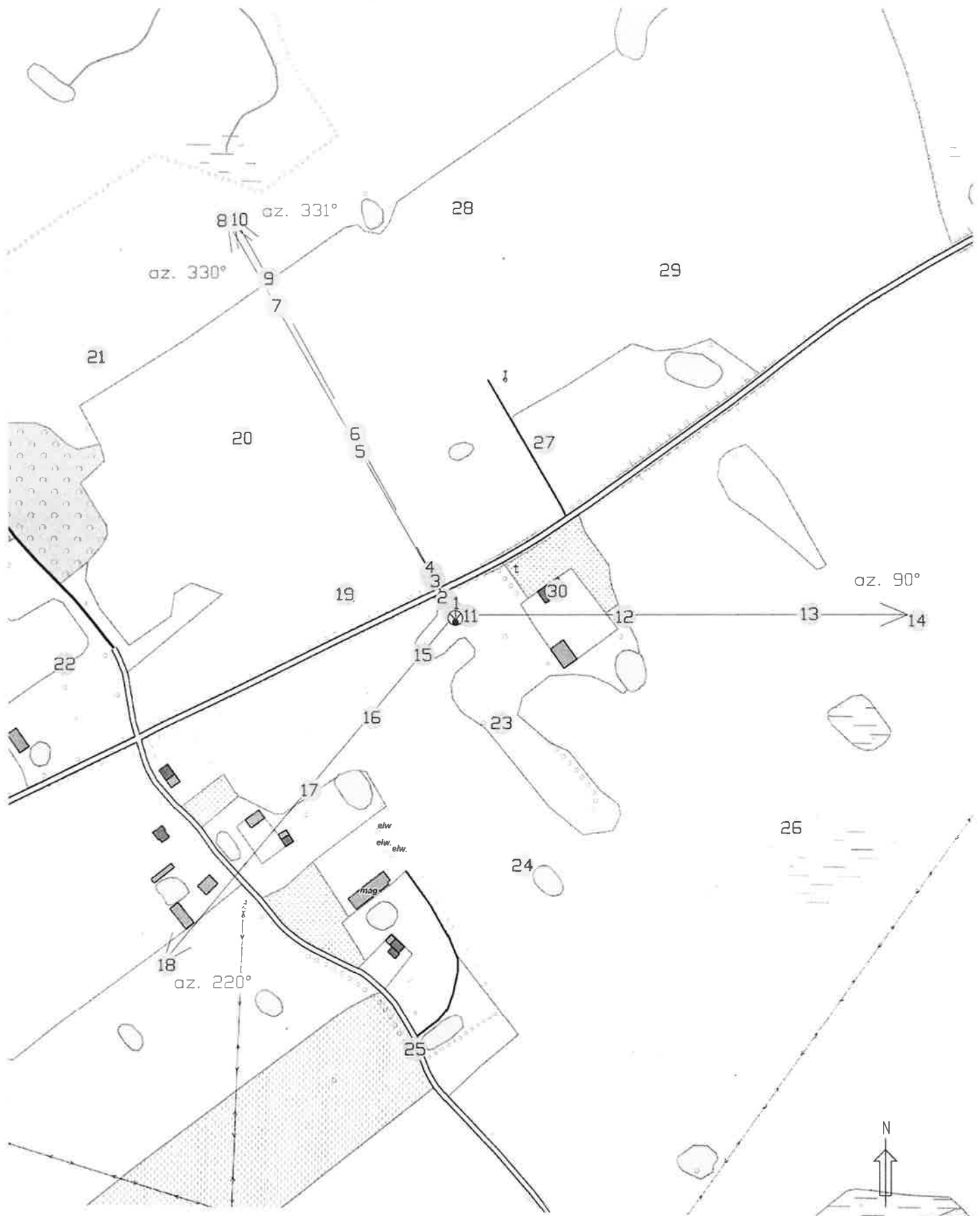
Rys.1 Lokalizacja pionów pomiarowych
