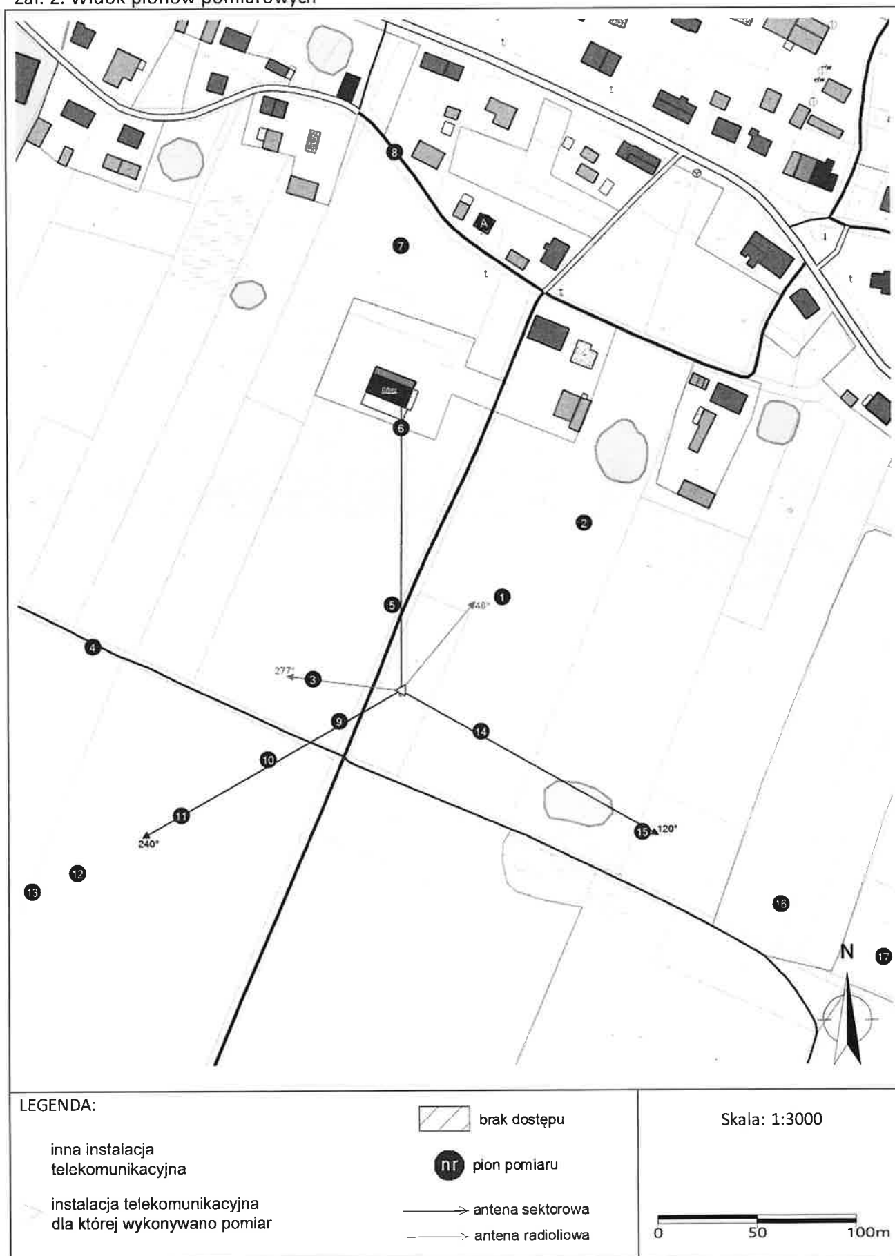
Załącznik 2. Widok pionów pomiarowych
